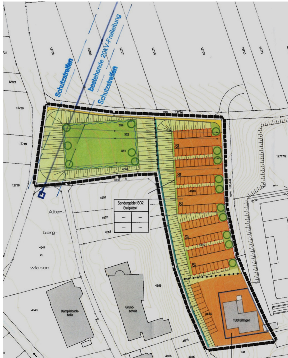
Lageplan Netze BW: 20 kV-Freileitung
