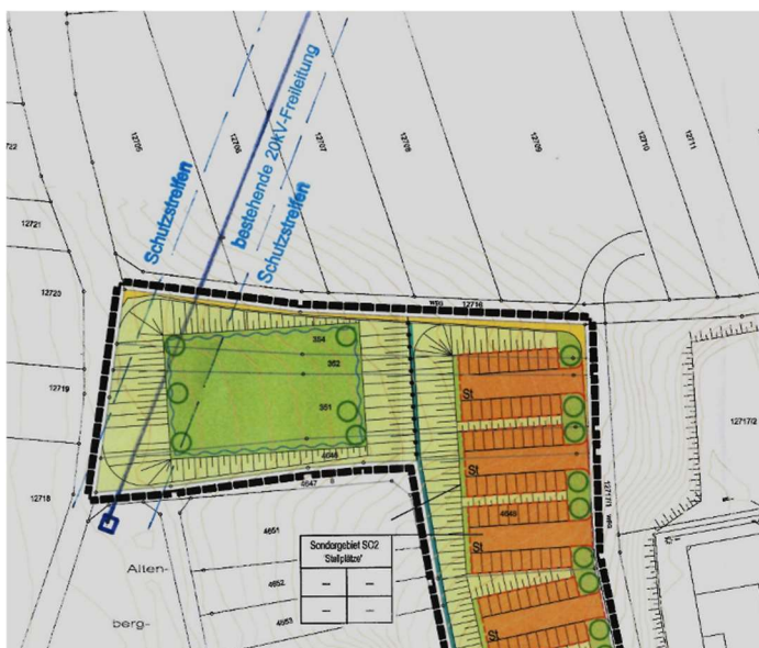
Lageplan Netze BW: 20 kV-Freileitung
